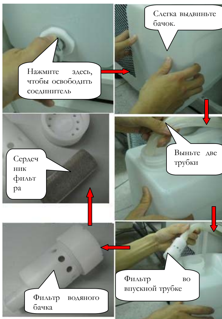
Figure 16.7 Извлеките сердечник фильтра бачка деионизированной воды
