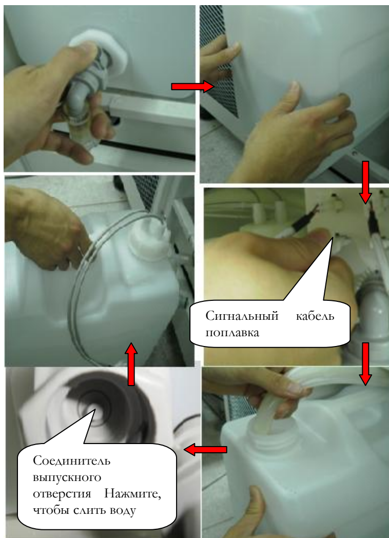
Figure 16.12 Выньте бачок деионизированной воды
