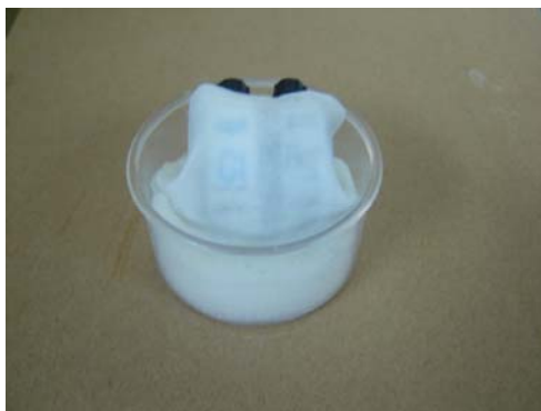
Figure 16.23 Оберните электроды марлей, смоченной буферным раствором
