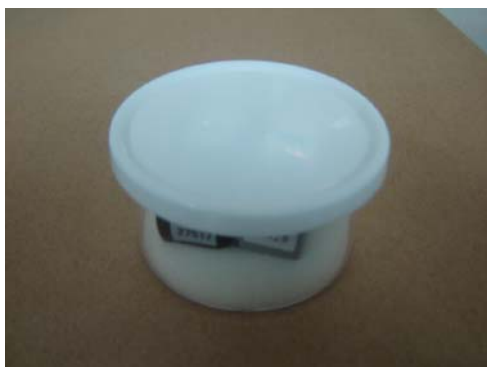
Figure 16.24 Закройте герметично коробку для электродов
