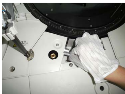
Figure 16.16 Снимите стопорный винт
