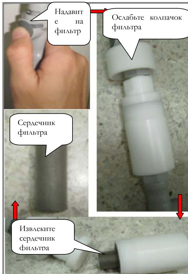
Figure 16.6 Снимите сердечник фильтра деионизированной воды
