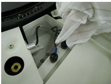
Figure 16.14 Снимите кабели лампы
