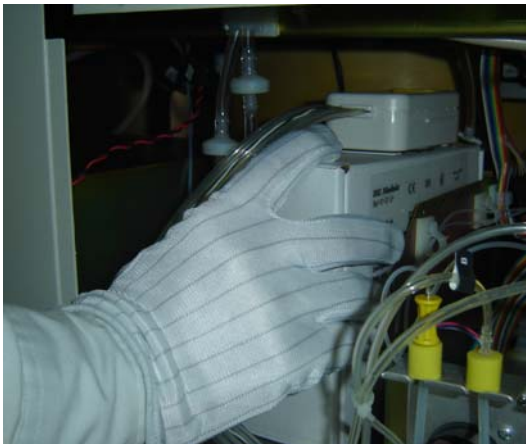
Рисунок 2-7 Установка стойки реагентов. Шаг 3.
