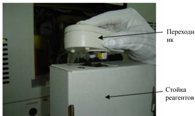
Рисунок 2-5 Установка стойки реагентов. Шаг 1.
