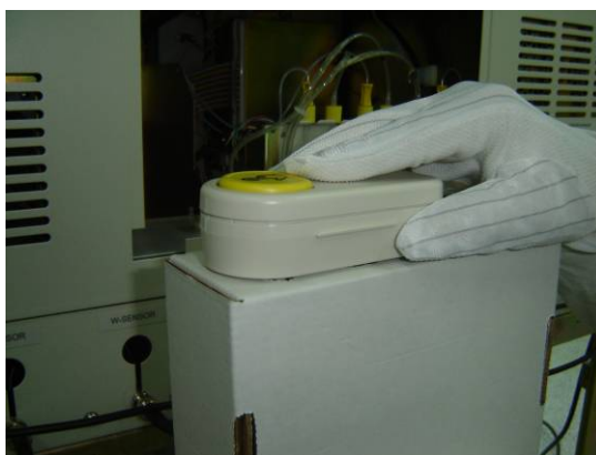
Рисунок 2-6 Установка стойки реагентов. Шаг 2.
