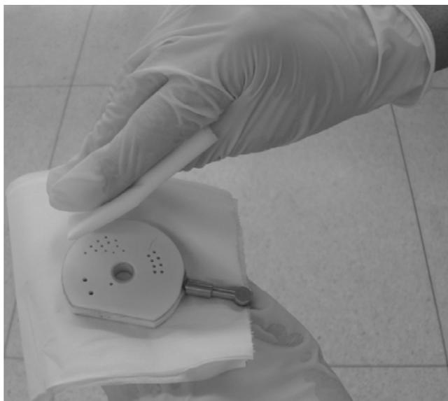
**Рисунок 10-53 Очистка контактных поверхностей**
