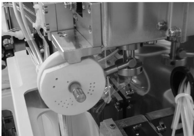
**Рисунок 10-54 Установка на место среднего клапана**
