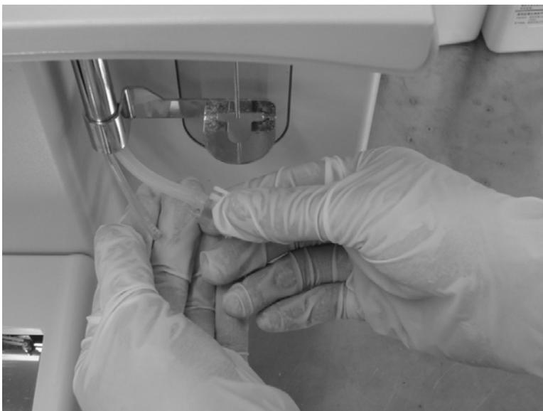
**Рисунок 10-55 Отсоединение зондоочистителя блока отбора проб в режиме открытого флакона**
