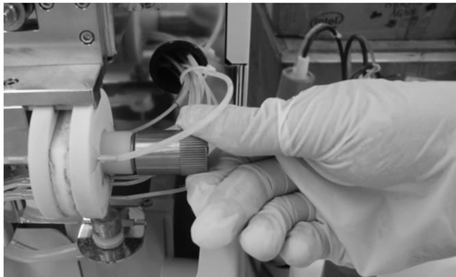
**Рисунок 10-50 Отсоединение винта постоянного давления**
