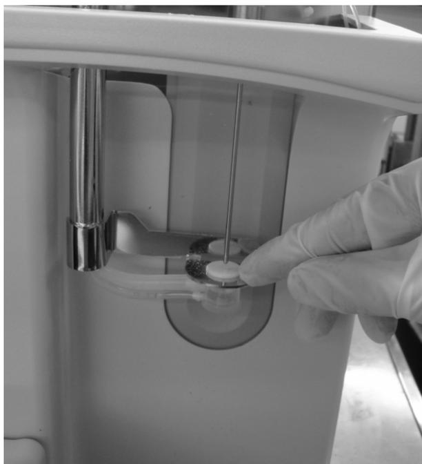
**Рисунок 10-49 Извлечение узла зондоочистителя**
