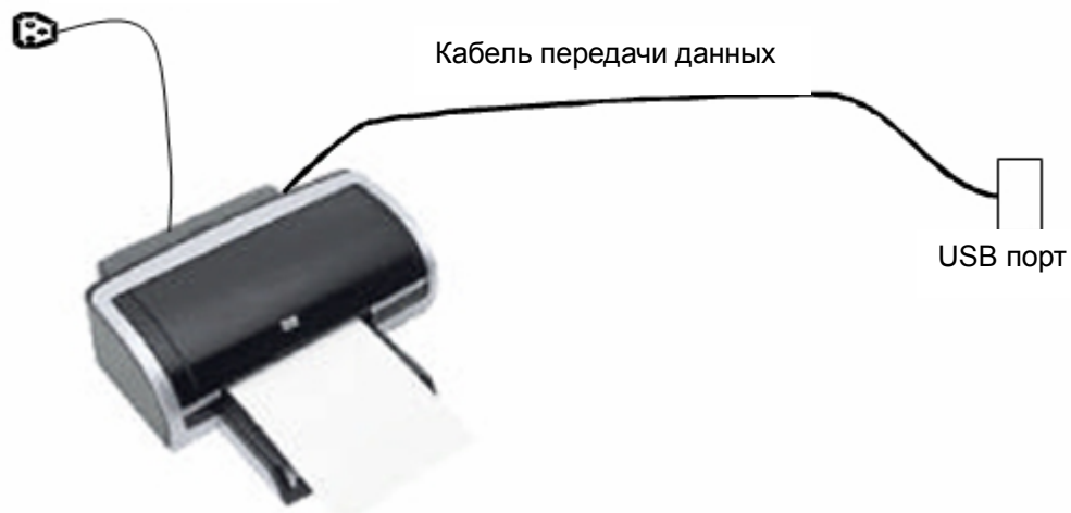
Рисунок 1-3 Подключение внешнего принтера Электрический шнур
