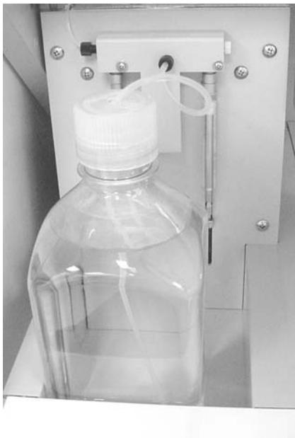
**Рисунок 2.3-2. Установленная бутылка Prime.**
